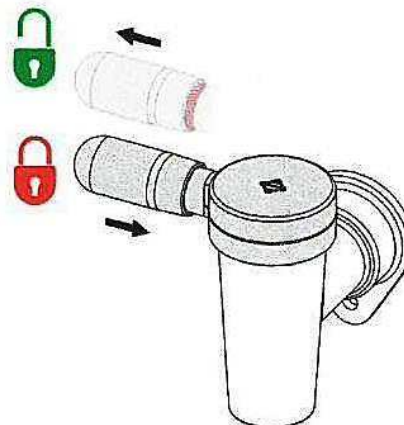
rys 12. Widok na zawór spustowy strawy w pozycji zamkniętej
